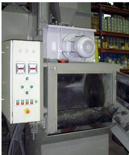
Una turbina ad alto rendimento **AGTOS** in una granigliatrice con trasportatore a rulli (sopra) e in una granigliatrice con tappeto rampante in gomma (sotto).
